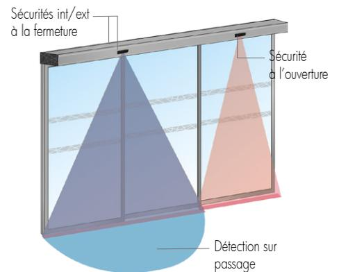
Des radars hyperfréquence intérieur et extérieur sont installés au-dessus du passage. Ils assurent l'ouverture automatique lorsqu'une personne se présente dans leur zone de détection.
