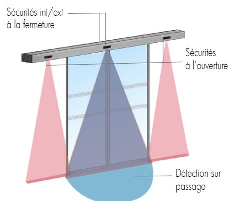
Des radars hyperfréquence intérieur et extérieur sont installés au dessus du passage. Ils assurent l'ouverture automatique lorsqu'une personne se présente dans leur zone de détection.
