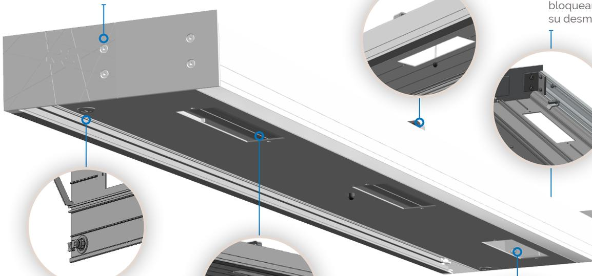
Dependiendo de la longitud de la trampa, se añaden soportes para mantener una buena rigidez y estabilidad en el conjunto.
