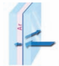
Doble vidrio aislante con gas Argón
